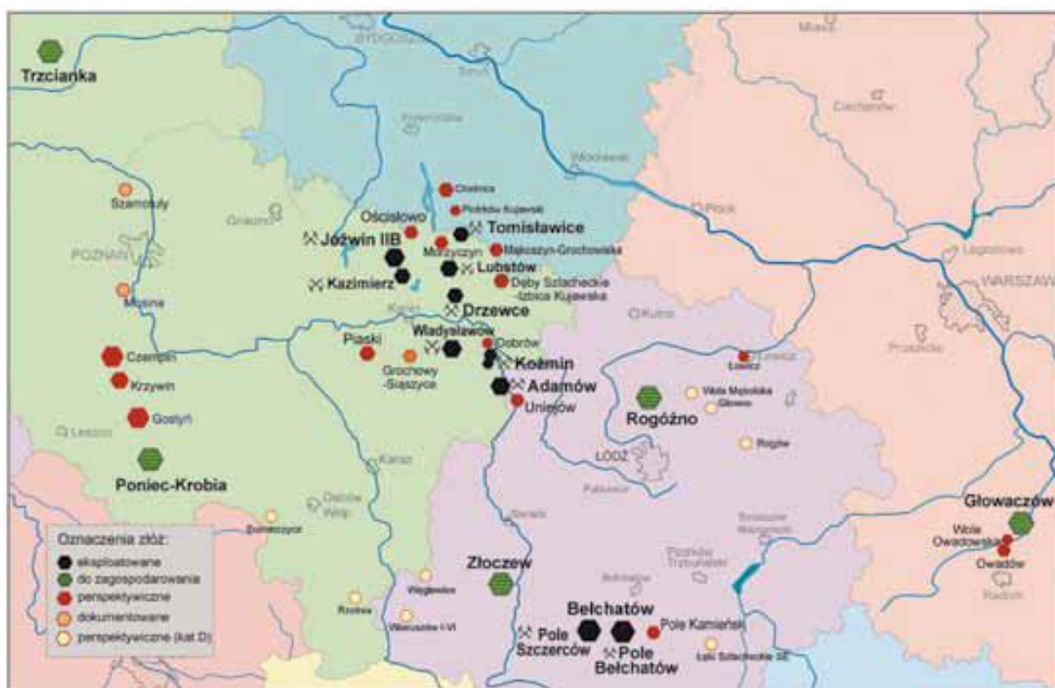
Rys. 1. Złoże węgla brunatnego rejonu zagłębia górnico-energetycznego adamowskiego, konińskiego, bełchatowskiego (Kasztelewicz i in. 2014)
